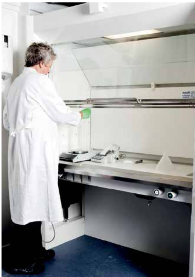
Figur 14. Stinkskabets hæve-sænke funktion kan bruges til at tilpasse stinkskabets arbejdshøjde til brugeren og arbejdsopgaven. Dette medfører bedre ergonomi samt en mere sikker håndtering af stoffer og materialer.
